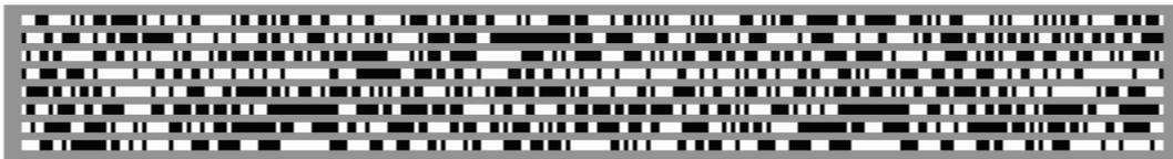
**Figure. 1.15** Exemple de code d'iris généré par la méthode Daugman
