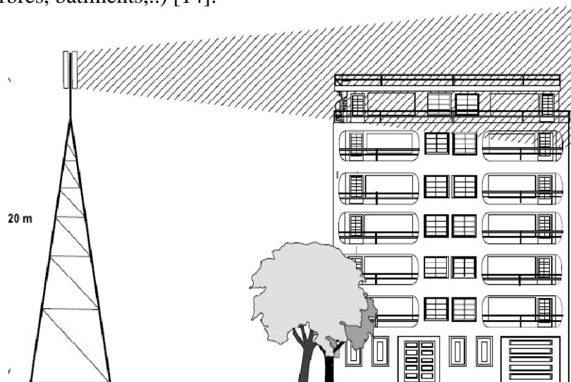
Figure.1.12 : Bâtiment situé dans le faisceau [16]
