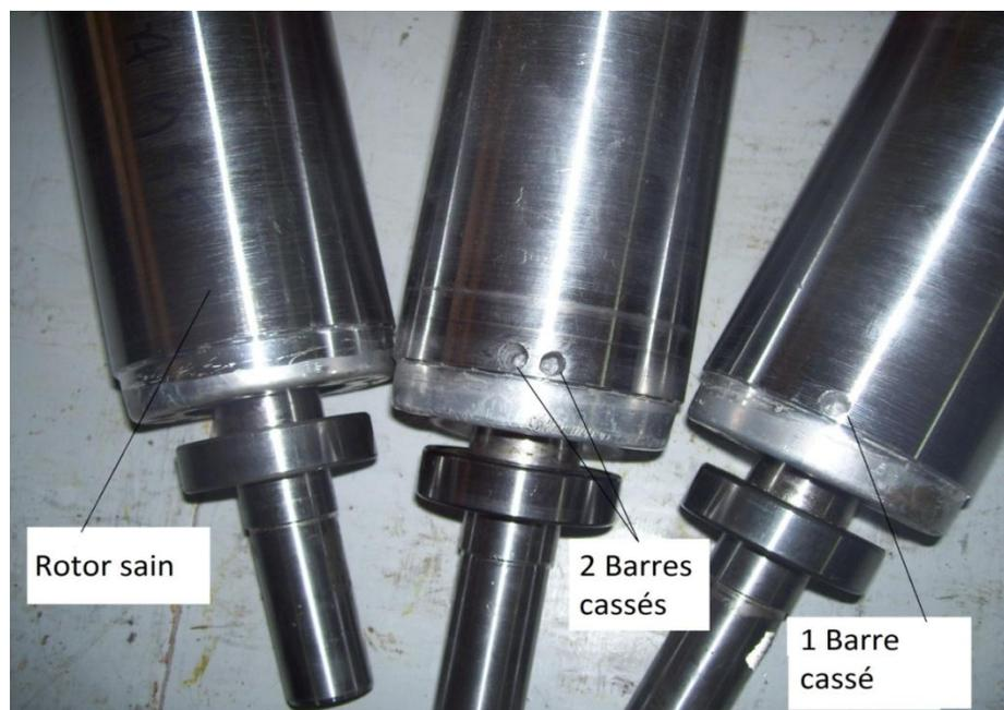
**Fig. III.2.** Rotors utilisés pour les différents essais.
