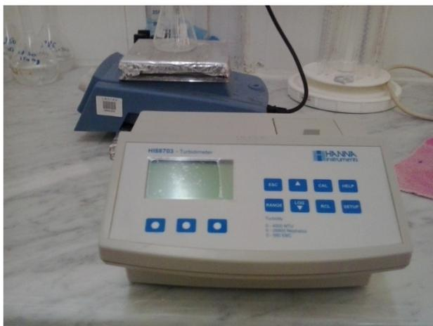
Figure I.9 : Turbidimètre
