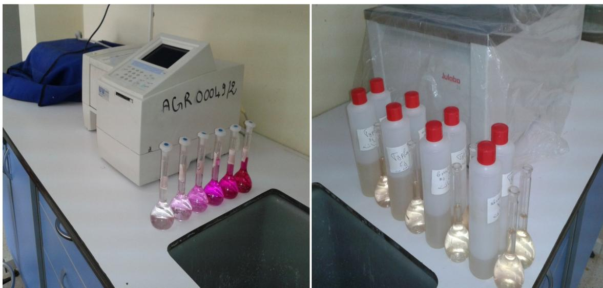
Figure I.13 : Spectrophotomètre UV – Visible
