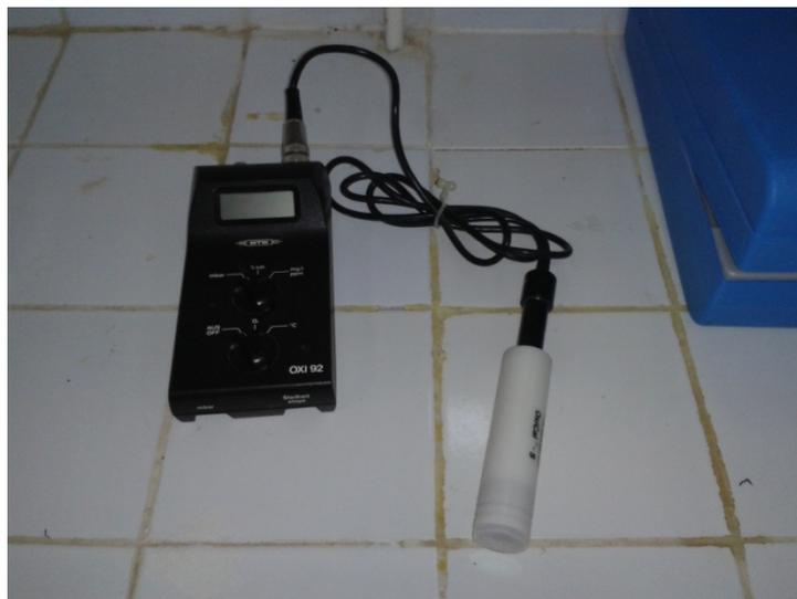
**Figure I.8 : Conductimètre**
