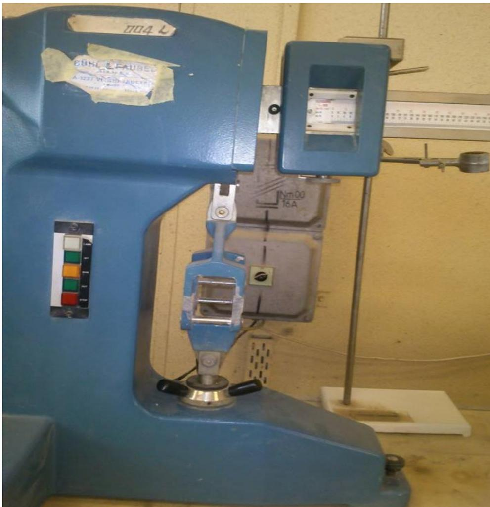
**Photo III.8 :** presse hydraulique pour l'essai de traction par flexion.
