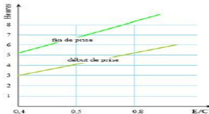
Figure I.4 : influence de l'E/C (eau/ciment) sur le temps de prise [12]
