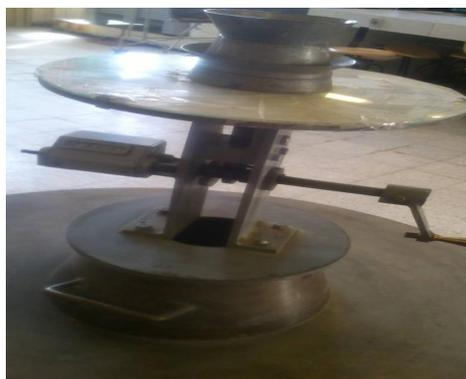
**Photo III.6** : Table à secousses.
