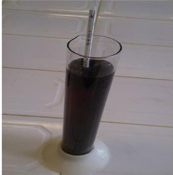
**Photo III.2 :** essai de densité d'adjuvant.
