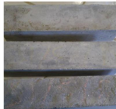
**Photo III.5** : les éprouvettes 4\*4\*16.
