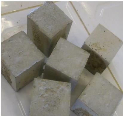
**Photo III.4** : les éprouvette 5\*5\*5
