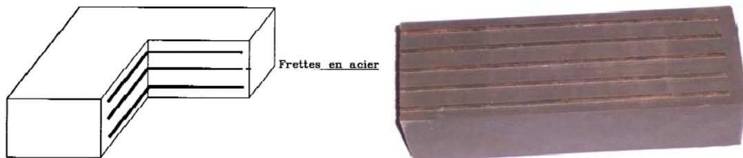
**Figure I.23: Schéma type d'un appareil d'appui en élastomère fretté (de conception actuelle).**
