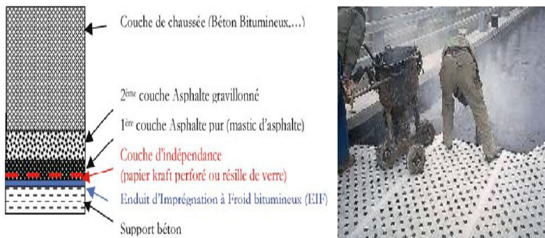
Figure. I.12: Etanchéité asphalte (guide MEMOAR du SETRA)
