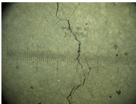
Figure II.13. Apparition des microfissures dans le béton BHPBC après chauffage(x24).
