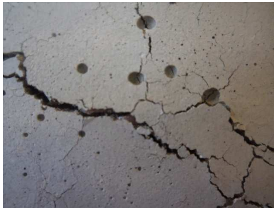
Figure II.12. Apparition des microfissures dans le béton BHRBC après chauffage(x24).
