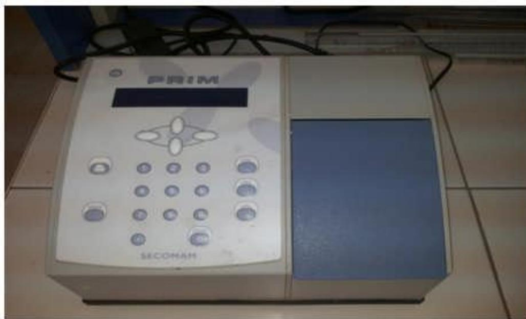
**Figure (7):** spectrophotomètre PRIM SECOMAM RS 232
