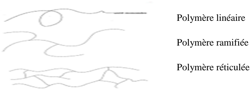
Figure (I-2): différents structure des polymères : structure linéaire, ramifiée et réticulée d'un polymère
