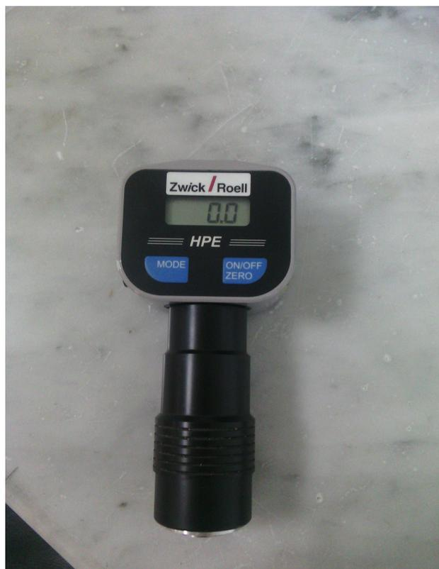
**Figure III.9** : Photographie de l'appareil servant à mesurer la dureté shore A (d'uromètre).
