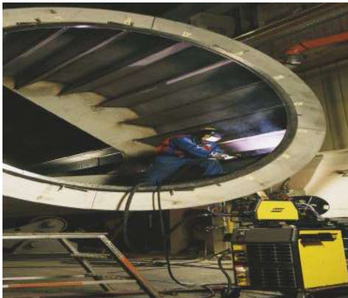
Figure II.5.a: du procédé de soudage MIG/MAG. [21]
