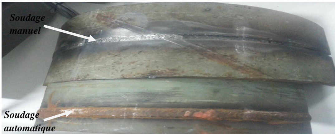
Figure .III.6: Les deux morceaux prélevés a partir pipelines soudé manuellement et automatiquement .
