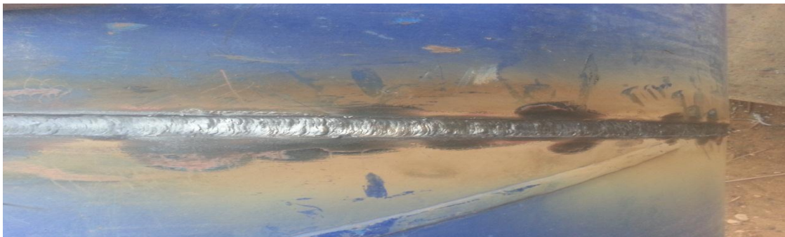
Figure III.1 : présente un joint de soudure obtenu par le procédé de soudage à l'arc électrique
