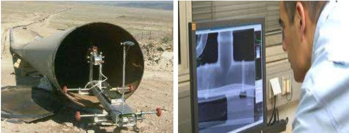
Figure .II.15: principe de contrôle par radiographie.
