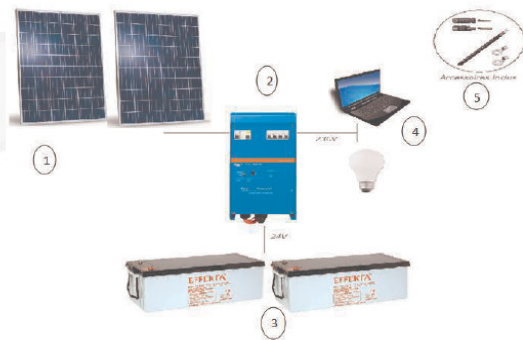
Système autonome avec stockage
