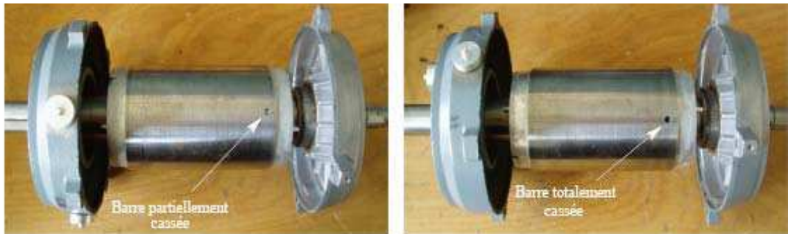
Figure (1.2) : Défaut de cassure de barre rotorique
