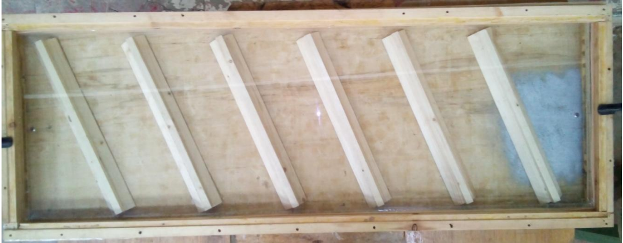
Figure (II.11) : Nervures et rainures disposées en forme inclinée.
