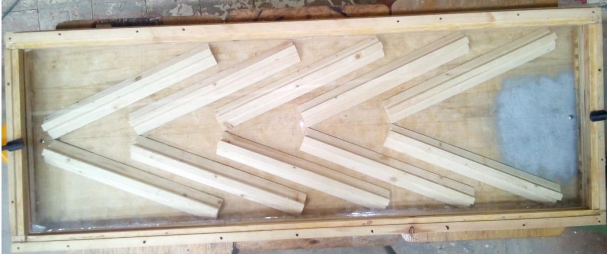
Figure (II.16) : Nervures et rainures disposées en forme de V.
