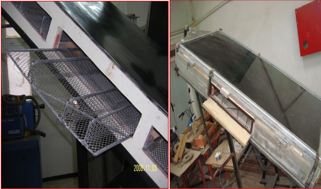
Figure.IV.3 : le banc d'essais pour le séchage solaire.
