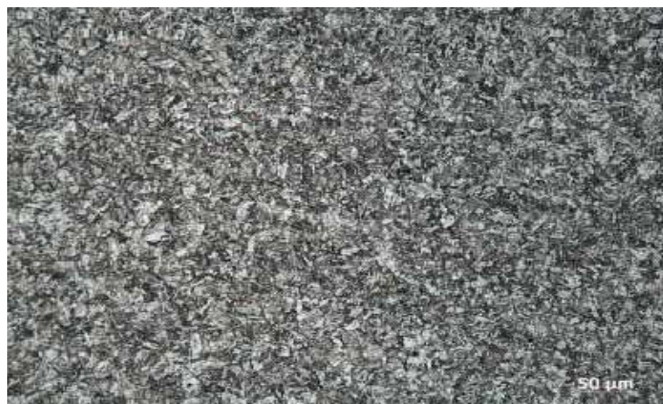
Figure. I.26 : Structure d'un acier inoxydable martensitique [35].
