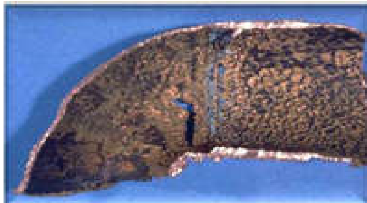
Figure. I.18 : La corrosion caverneuse [29].
