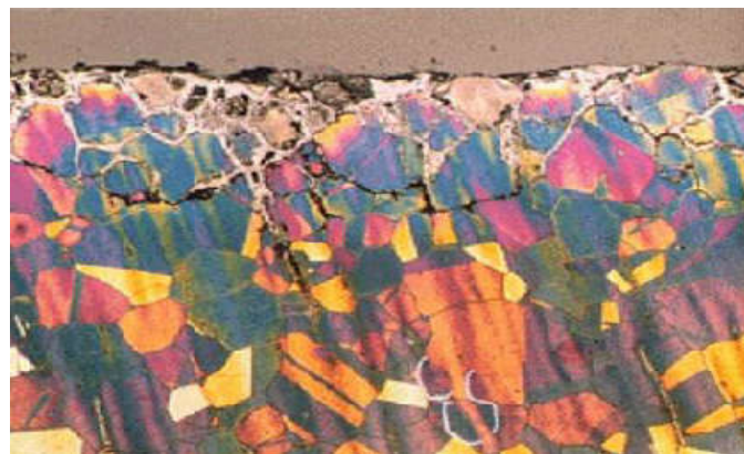
Figure. I.19 : Corrosion intergranulaire d'un inox par HCl [11].
