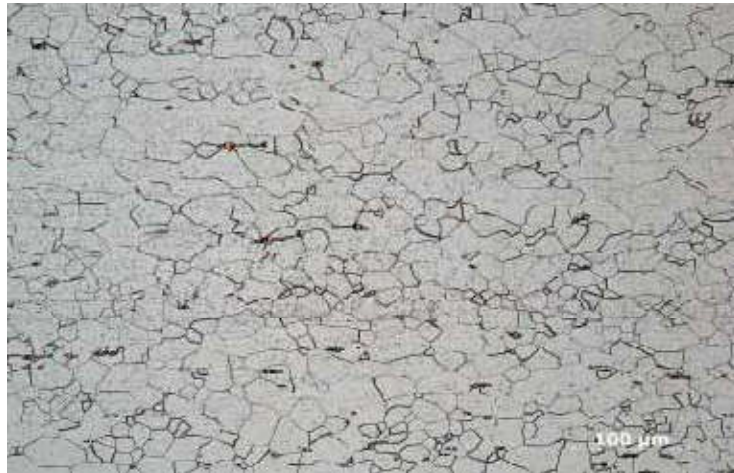
Figure. I.25 : Structure d'un acier inoxydable ferritiques [35].
