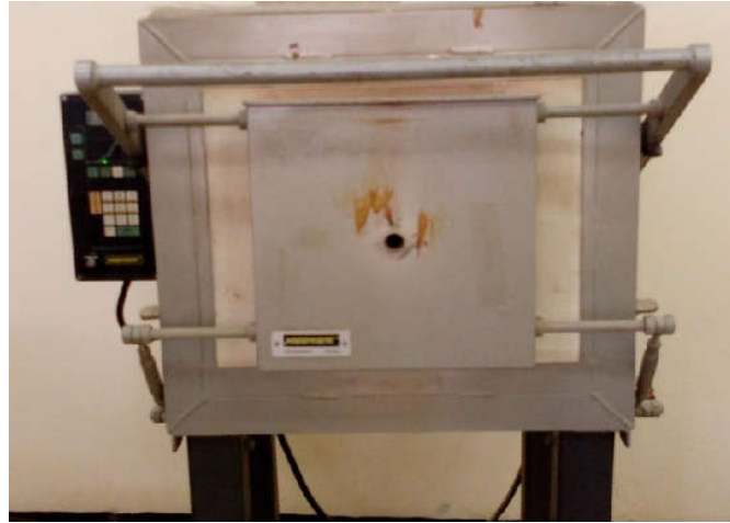
Figure. II.3 : Four de Traitement Thermique de type Nabertherm.
