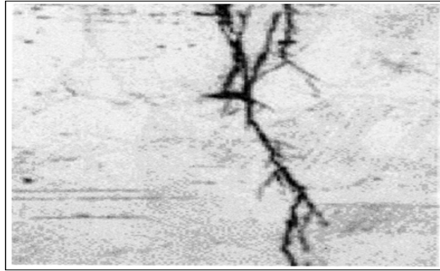
Figure. I.14 : La corrosion sous contrainte d'un acier inoxydable [27].
