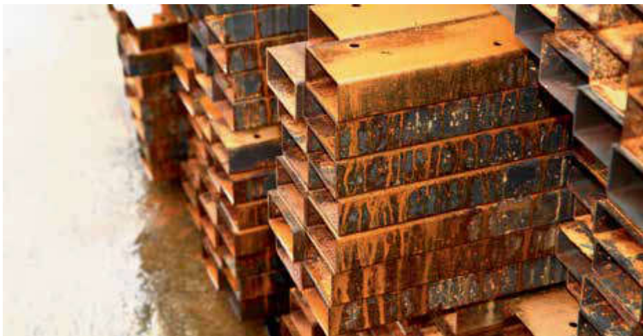
Figure. I.2 : Corrosion d'éléments en acier [5].
