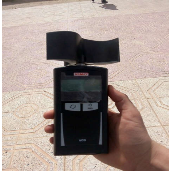
Fig. IV.6. Anémomètre à coupelles
