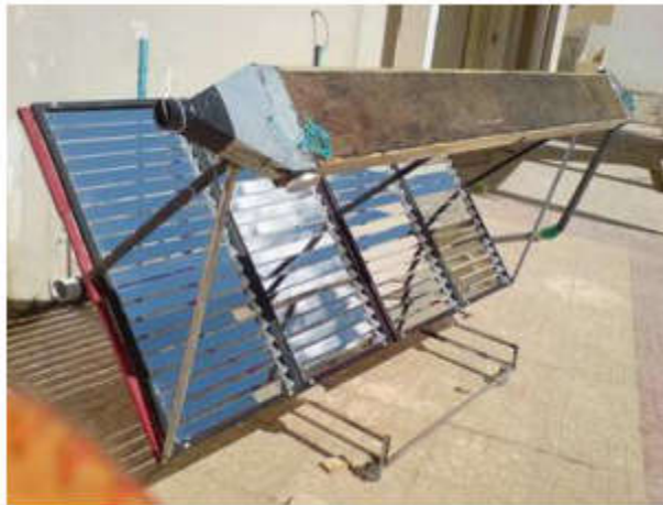
Fig. I.6. Capteur solaire à quatre éléments avec jeux de miroirs pivotants de type fresnel [4]
