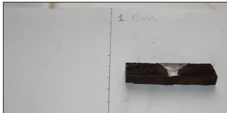
Figure 3-12 : aspect macroscopique de l'acier et son joint soudé sans produits de corrosion (HCl 1M).
