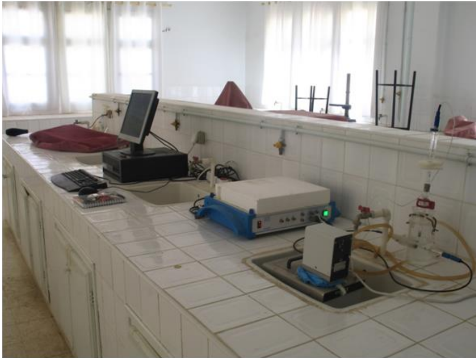
Figure 2-2: Photographie du dispositif de mesures électrochimiques
