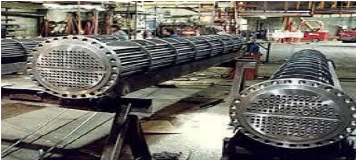
**Figure. II.2.** Echangeur à faisceaux et calandre 1-2 type AEL [6]
