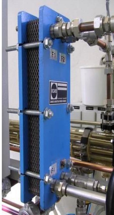
**Figure. II.6.**échangeur à plaques soudées ou cassettes [6]
