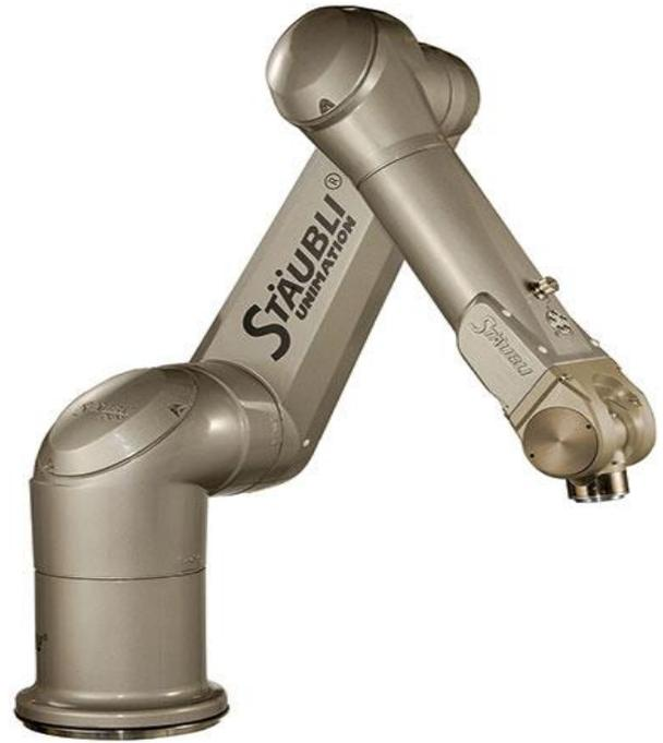
FIGIII.5 : Robot 6 axes RX160 [19].
