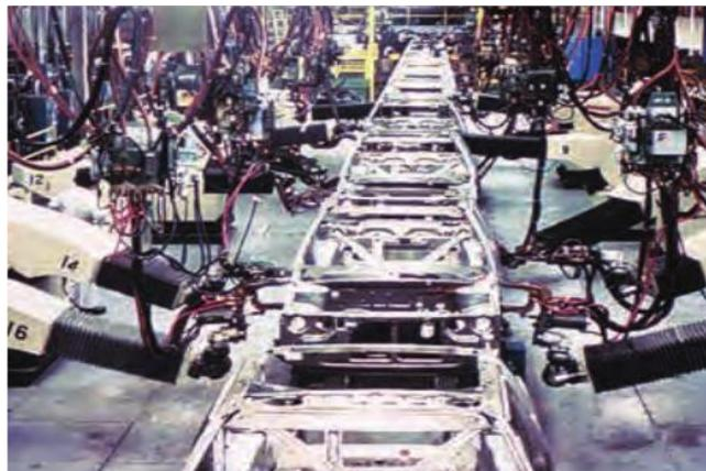
FIG I.29 : Robot de soudage [12].
