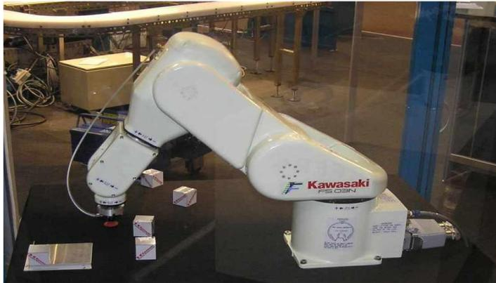
FIG I.26 : Un robot industriel Kawasaki FS-03N, robot de soudage [1].
