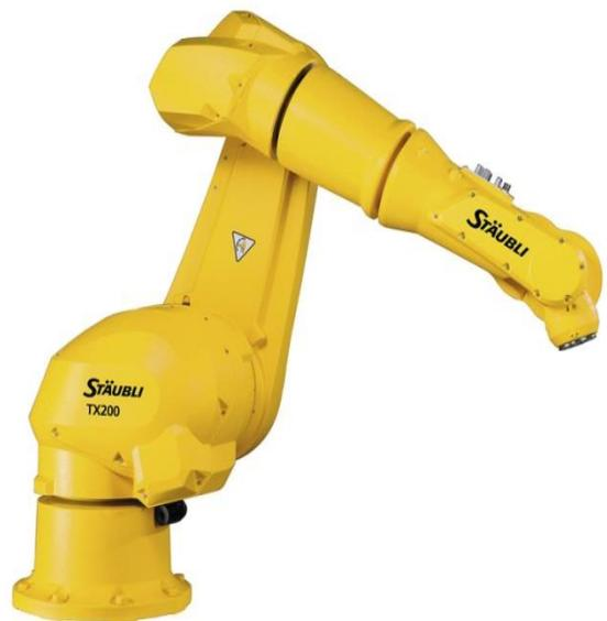
FIGIII.3 : Robot articulé 6 axes de Palettisation TX200 [19].
