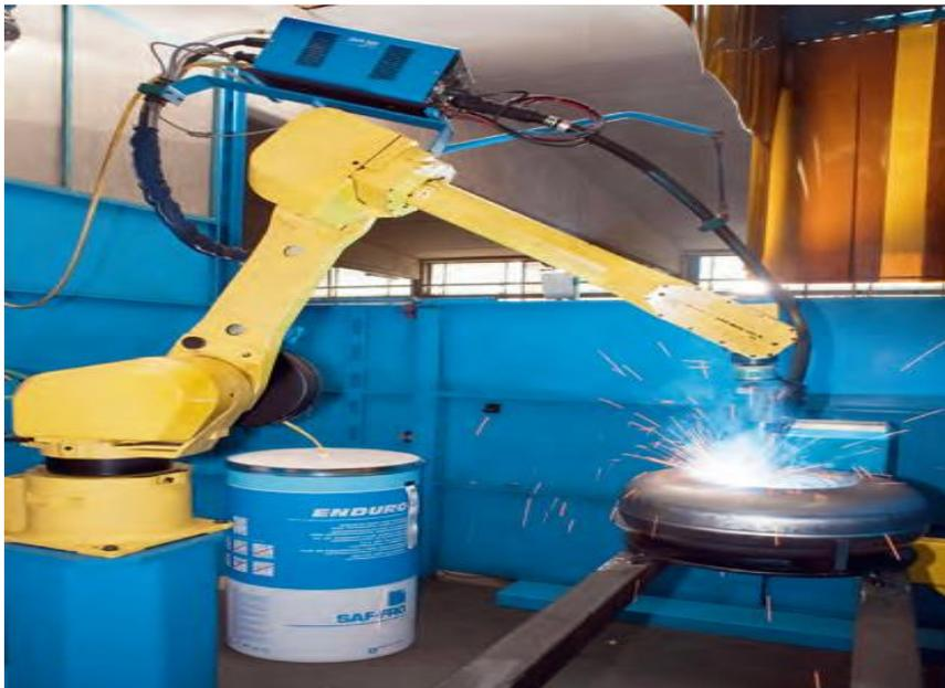
FIG I.34 : Robots industriels de Soudage [13].
