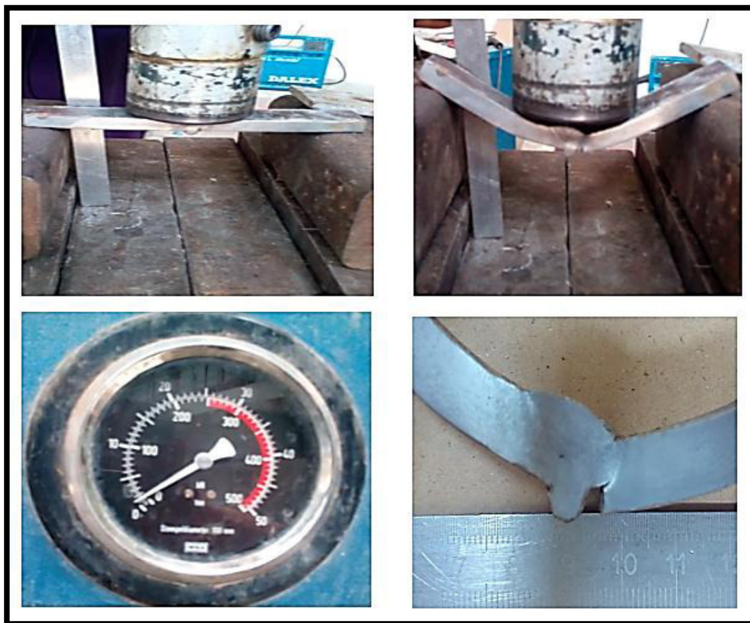
Figure III.29 : Teste de pliage échantillon avec manque de fusion dans la racine .
