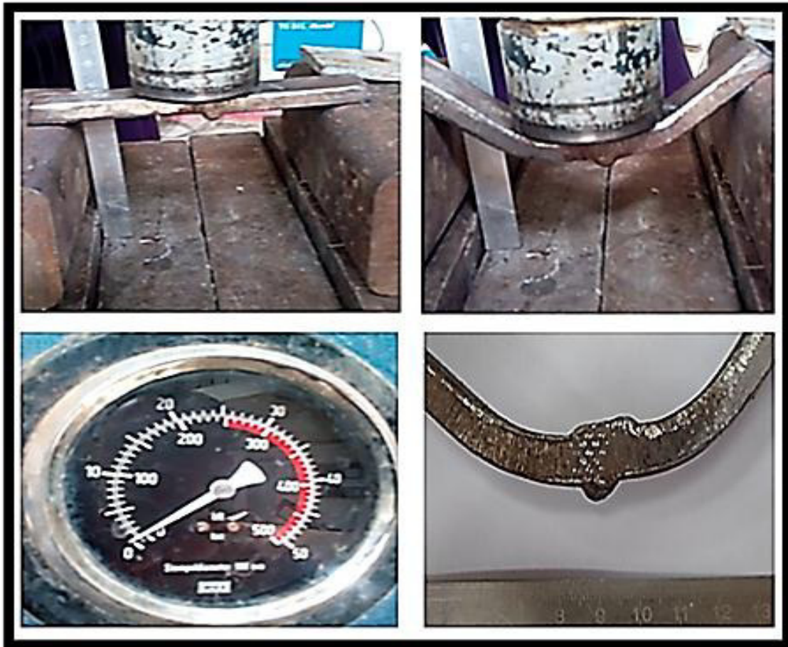
Figure III.30 : Teste de pliage échantillon sans défaut de soudage.
