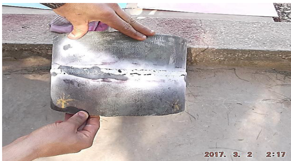
Figure III.18 : Joint de soudure après ressuage.
