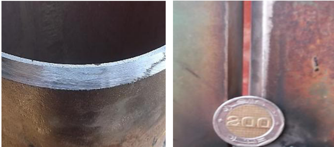
Figure III.5 : Préparation du chanfrein.
