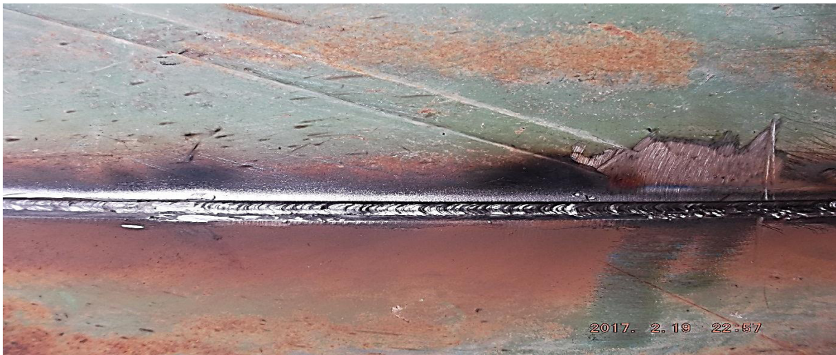
Figure III.9 : La première passe de soudage
