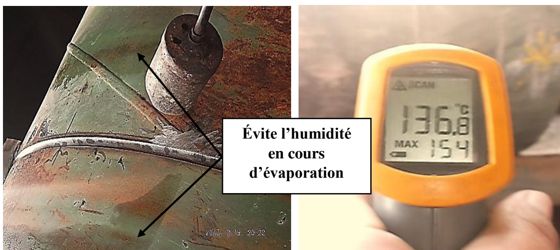
Figure III.7 : Le chauffage de la pièce par le chalumeau.
