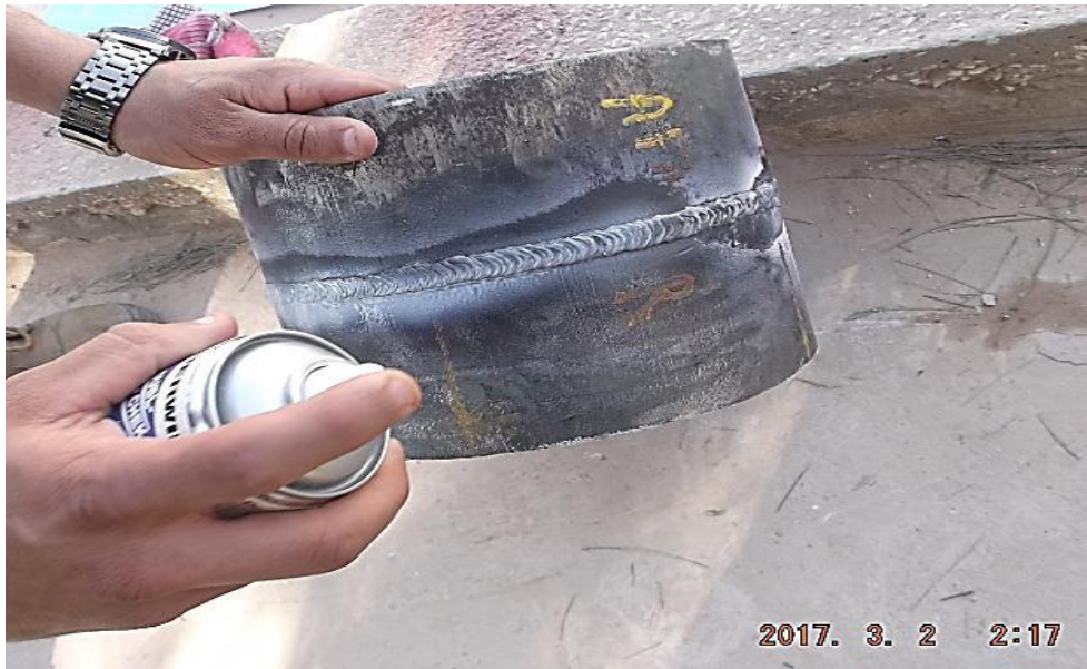
Figure III.17 : Application du révélateur.
