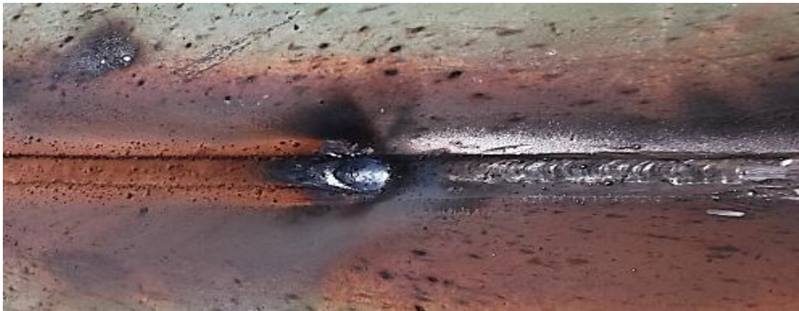
Figure III.4 : Un joint de soudure obtenu par le procédé de soudage à l'arc électrique.
