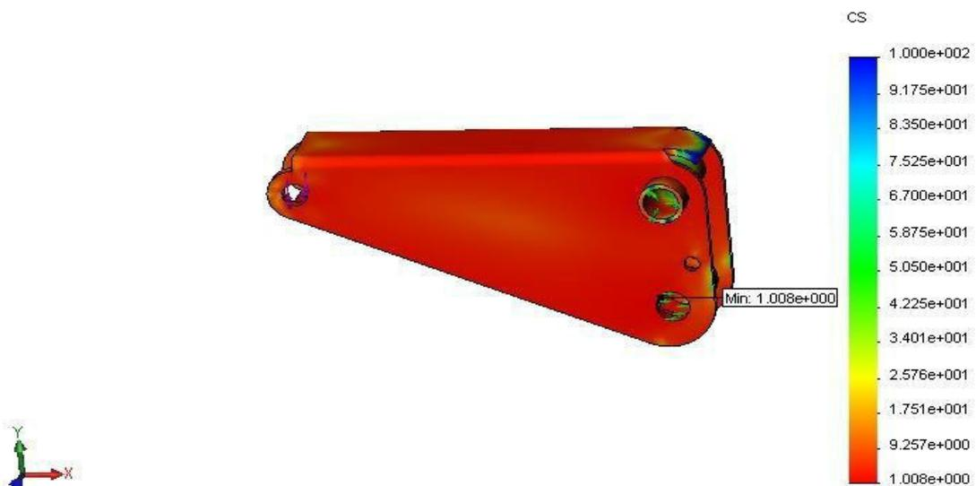
Figure III.13: Contrôle de conception avec contrainte von mises au bar de levage modifié
