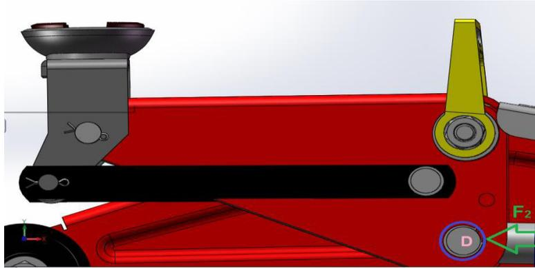
Figure II.26:axe entre le piston et le bras de levage
