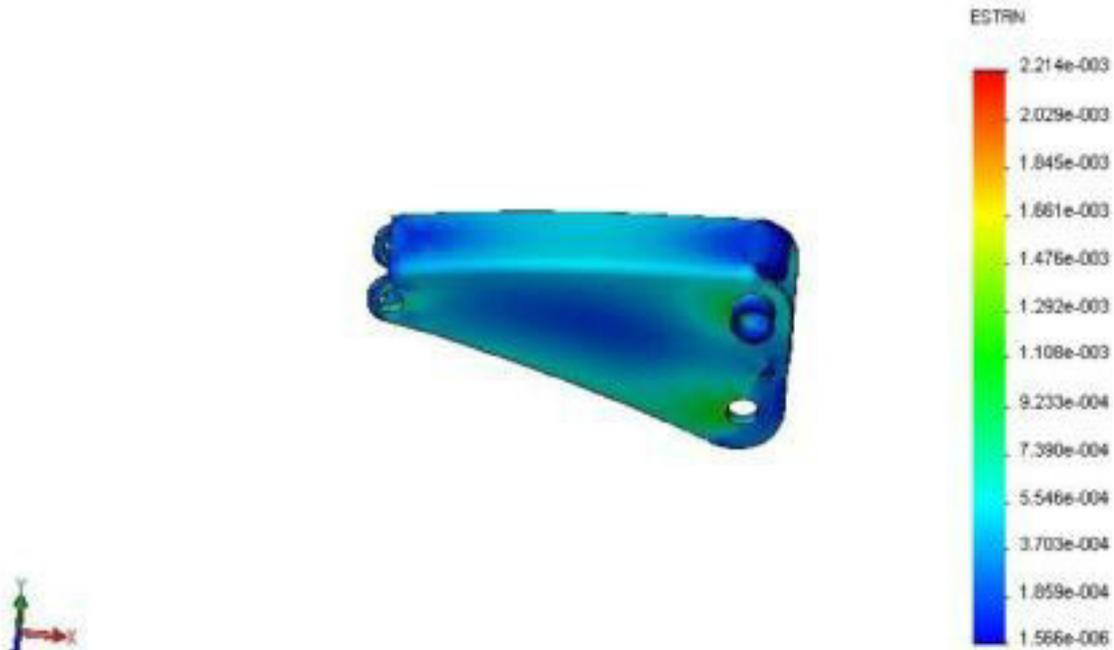
**Figure III.7:** Déformations au bras de levage
