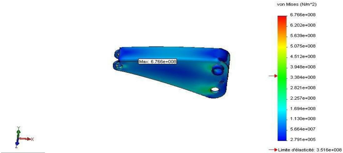
Figure IV.5: Contraintes de Von Mises au bras de levage
