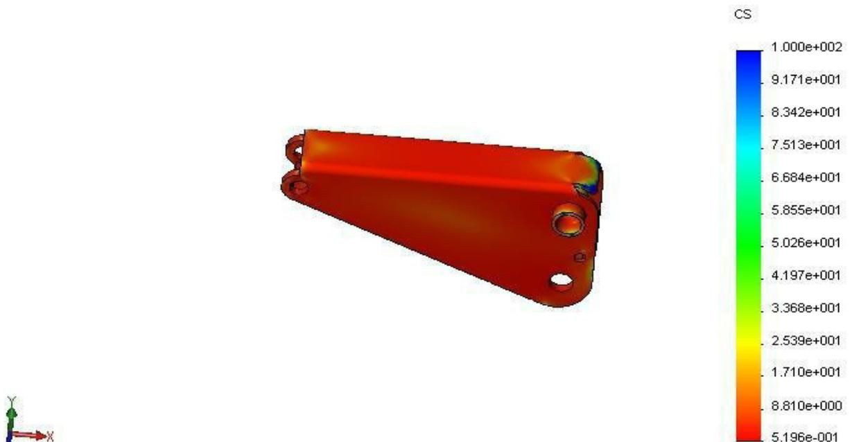
Figure III.8:Contrôle de conception avec contrainte de Von mises au bras de levage
