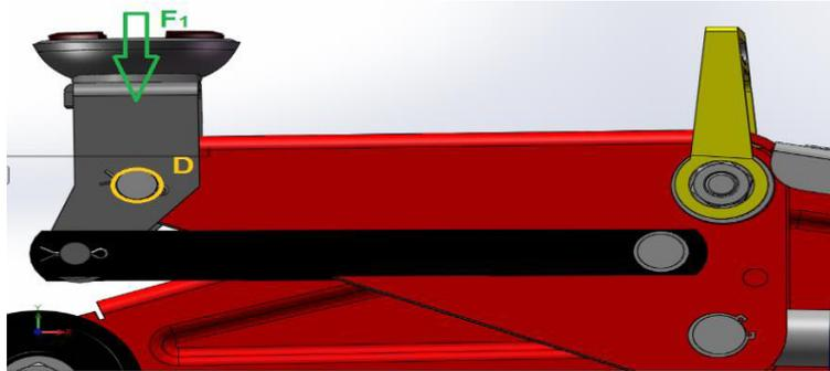
**Figure II.24:**axe le bras d'articulation et le bras de levage
