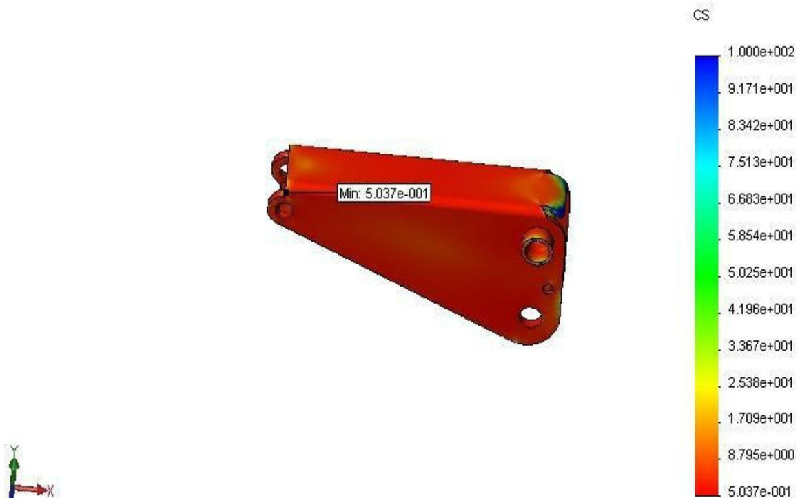
**Figure III.9 :** Contrôle de conception avec contrainte de cisaillement au bras de levage
