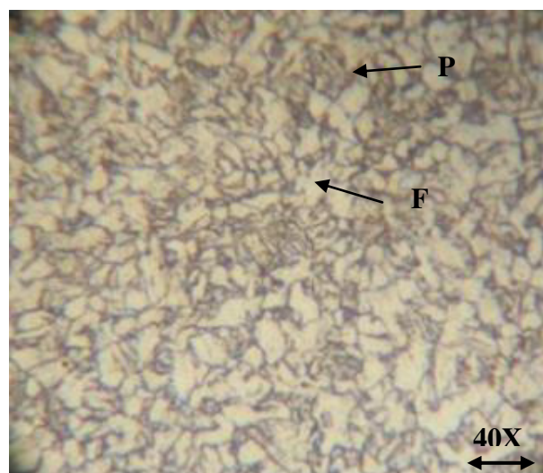
Fig.IV.1: Examen métallographique optique de l'acier (état brut).
