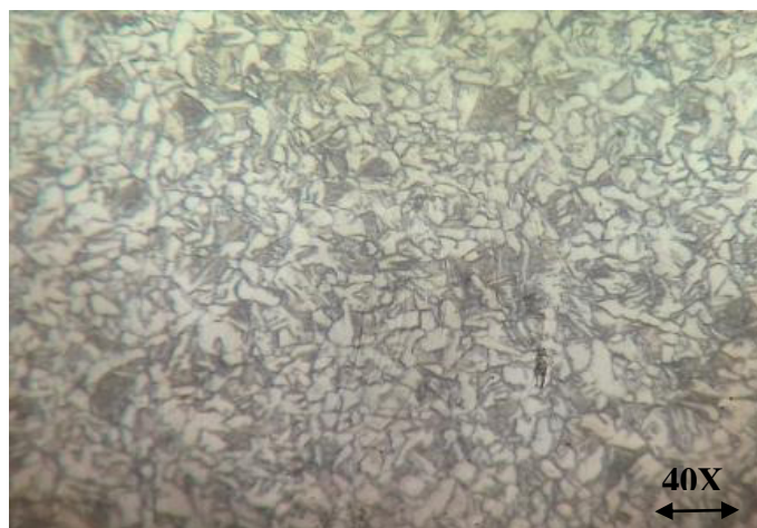
Fig.IV.4: Examen métallographique optique de l'acier (revenu à 220 °C pendant 60 min).
