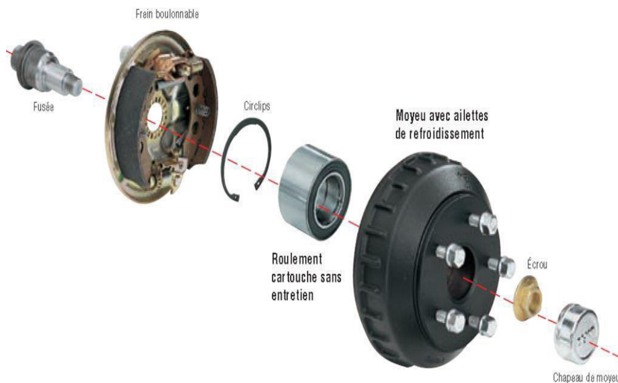
Figure 3.5 : Composants de moyeu modernes
