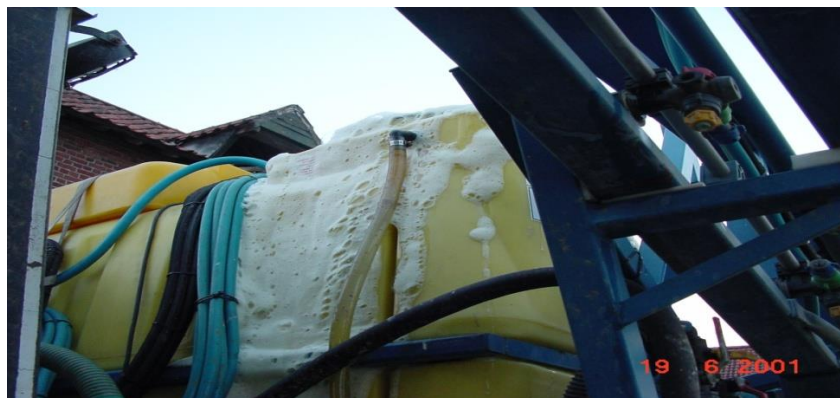
Figure 8 : le débordement du produit du la cuve du pulvérisateur (Boukahlfa,2017)
