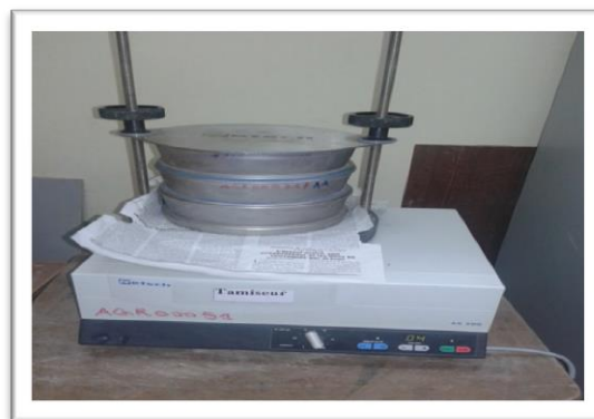
Figure 13 : Technique d'analyse granulométrique (original)
