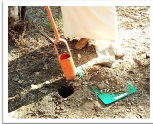
Figure09 : la prélèvement de sol(original)
