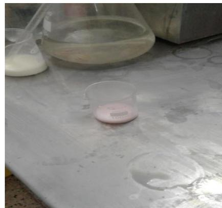
**B.** En ajoutant une solution d'hydroxyde de sodium N/9 tout en agitant par rotation jusqu'à apparition d'une coloration rose pâle « **Virage au rose** ».
