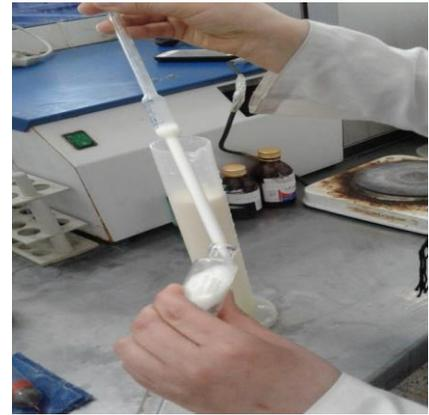
**B.** Plaçant le lait au-dessus de l'acide sulfurique.
