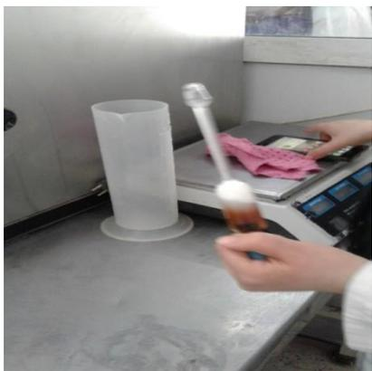
**C.** L'agitation manuelle du butyromètre.
