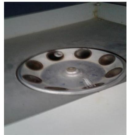
**D.** Le butyromètre est dans la Centrifugeuse.
