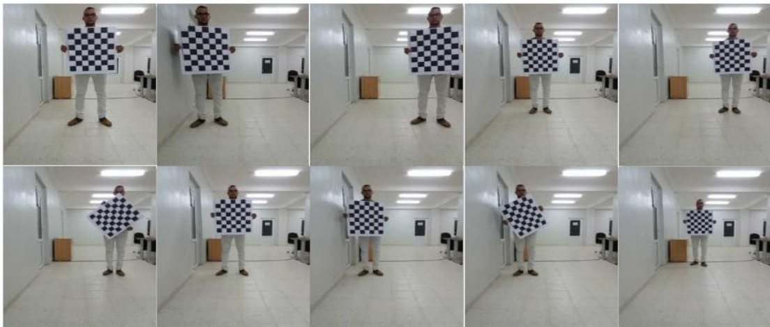
Figure 3. 16 Série d'images acquises pour la calibration (caméra gauche)
