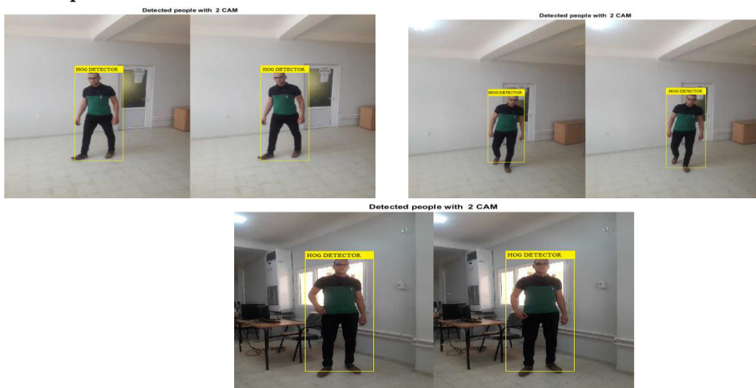
Figure 2. 31 Détection d'une personne en mouvement indoor avec différentes variantes (lumière, profil, distance)
