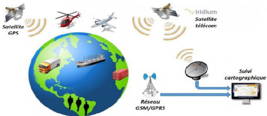
Figure 1. 7 Exemple d'architecture de localisation par GSM [Google]
