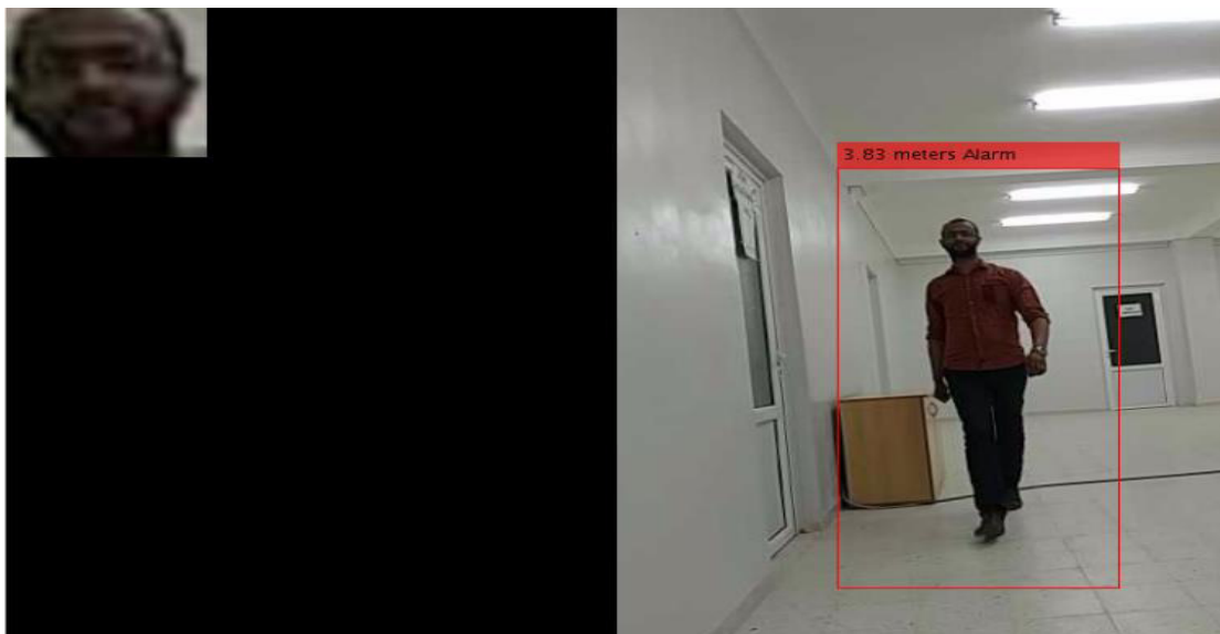
Figure 3. 32 Exemple de détection, localisation et avertissement
