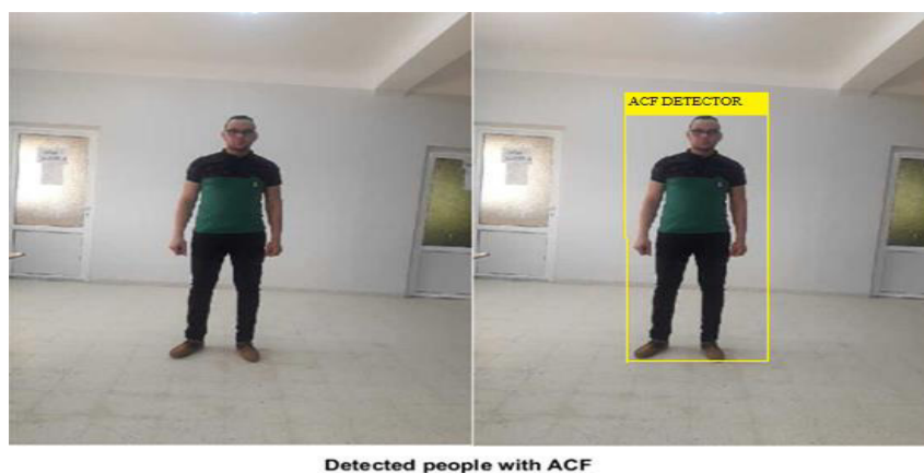
Figure 2. 25 Détection par méthode ACF (variante distance et lumière)
