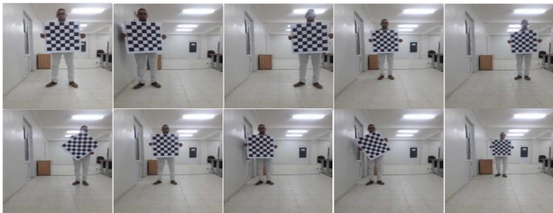
Figure 3. 17 Série d'images acquises pour la calibration (caméra droite)
