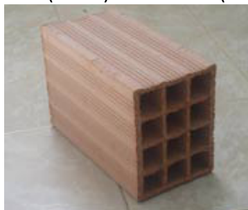
Figure 1.3 : Brique ordinaire perforées de 12 trous.
