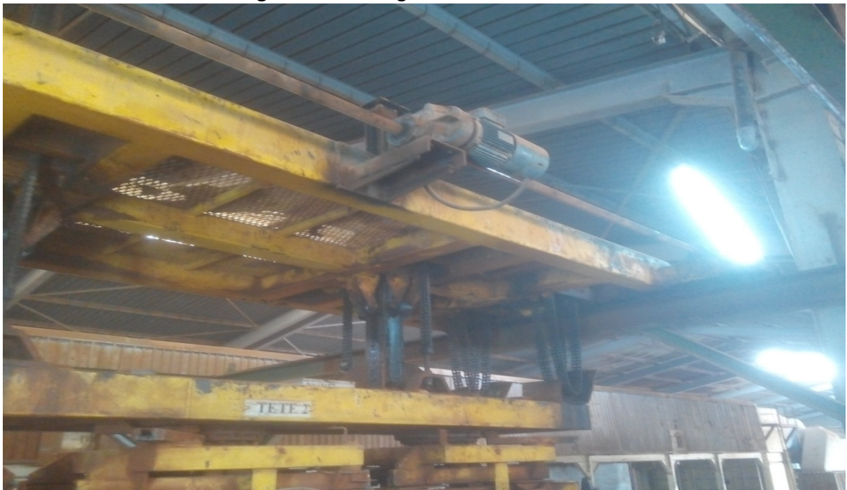
Figure 3. 11 :moteur triphase pour translation la pince.
