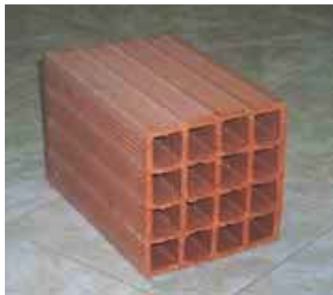
Figure 1.5 : Brique ordinaire perforées de 16 trous.
