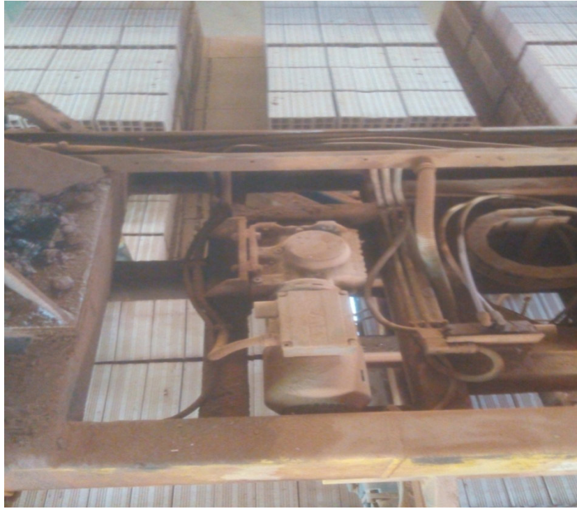
Figure 3.5 : moteur triphasé au dessous de la tête 2.
