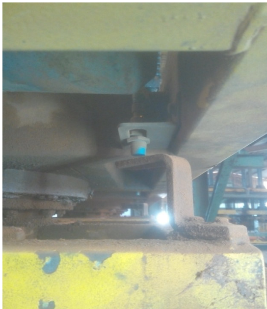
Figure3.9 : détecteur 24v pour rotation de la tête.
