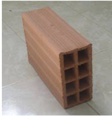
Figure 1.4 : Brique ordinaire perforées de 8 trous.
