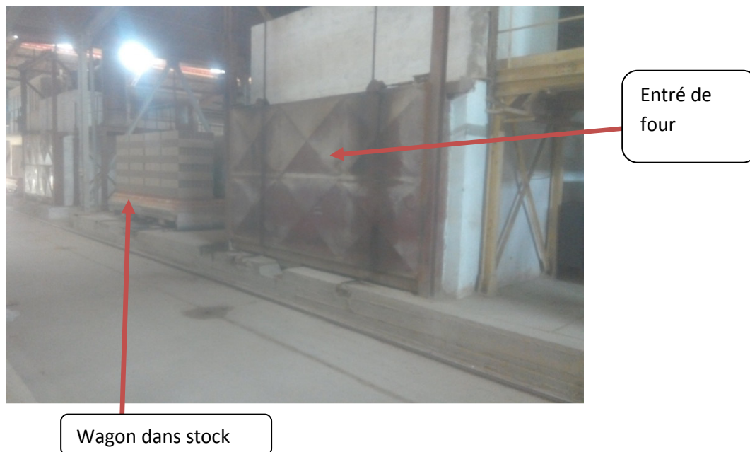
Figure 1.15 : l'entrée de briques préparées au four.
