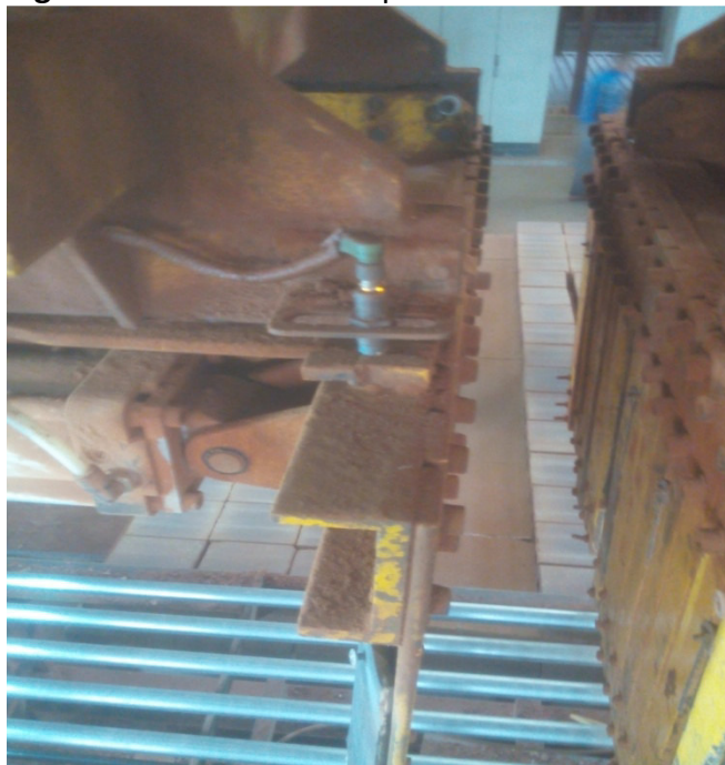
Figure3. 10 : détecteur 24V pour l'ouverture.
