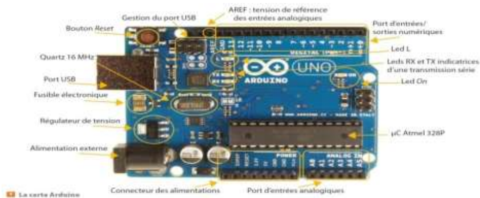
Figure II.8: Description de la carte Arduino Uno.
