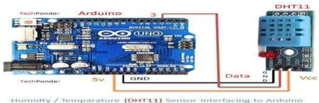
Figure IV.2 : connexion de la DHT11 avec la carte arduino.
