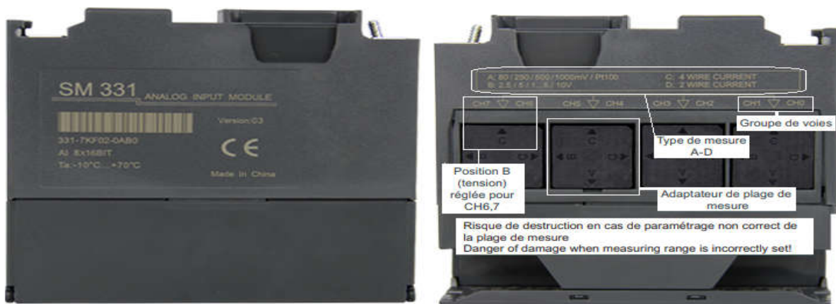
Figure (II.19) : Position des adaptateurs de plage de mesure.
