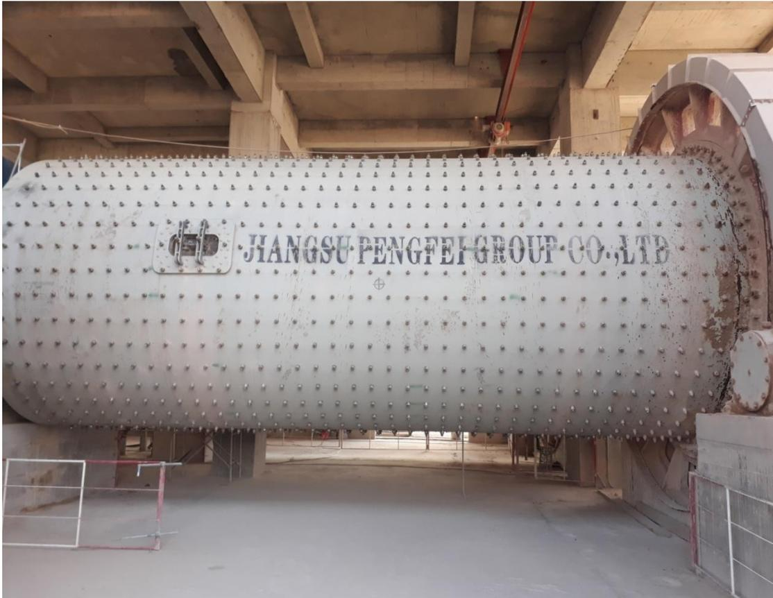
**Figure I.10 Le Broyeur cru [1]**
