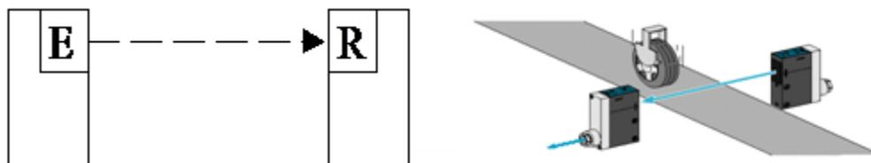
**Figure II.9 Capteur photoélectrique système barrage[2]**
