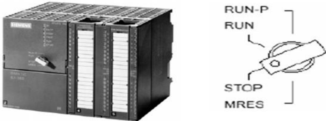
**Figure IV.7** Vue extérieure d'automate S7-300[6]
