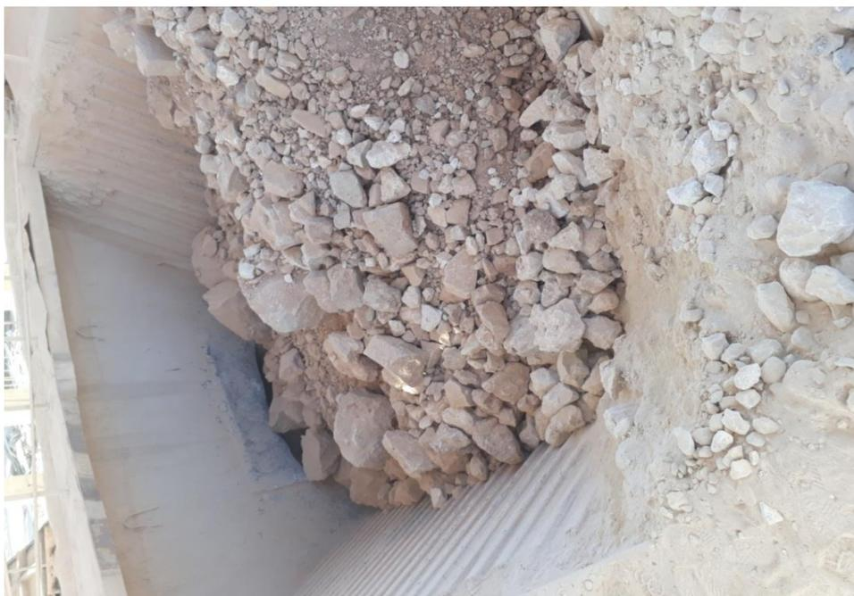
Figure I.2 Le trémie de concasseur [1]
