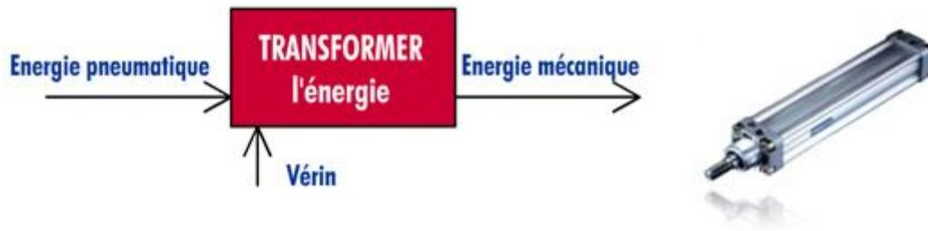
Figure II.3 Le vérin pneumatique et leur fonctionnement[2]
