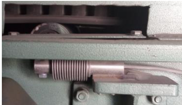
Figure III.4 Position de cellule de pesage dans le doseur
