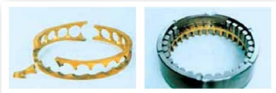
Fig. I.10 : Détérioration de cage.
