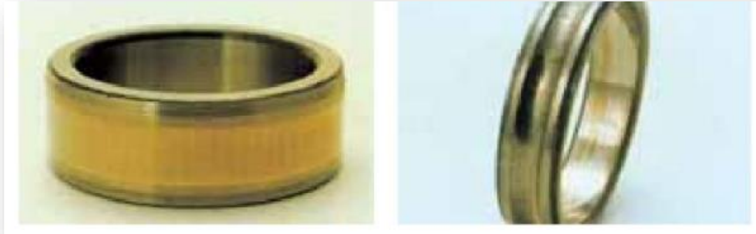
Fig. I.14 : Corrosion de contact.
