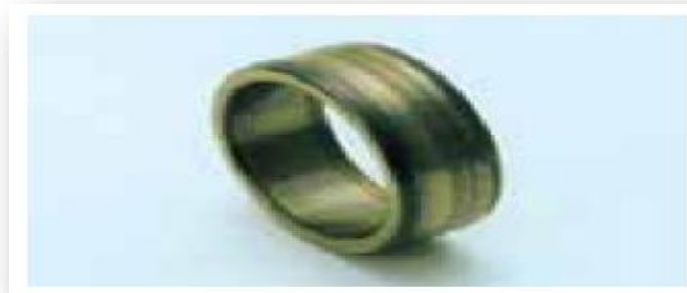
Fig. I.15 : Usure (modification de la précision géométrique).
