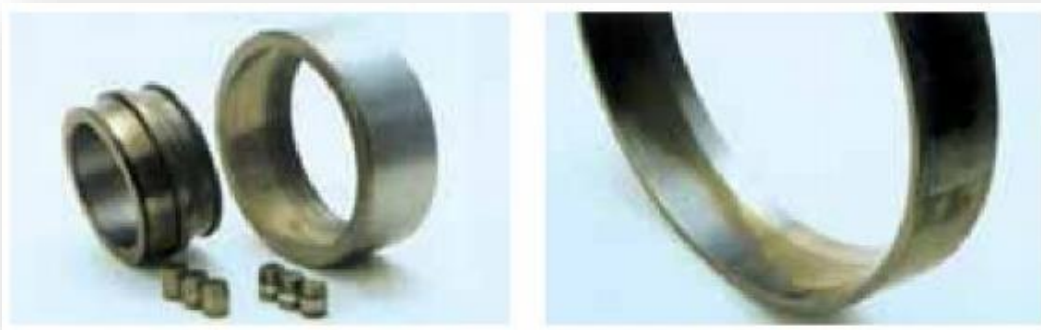
Fig. I.11 : Déformation du chemin de roulement.
