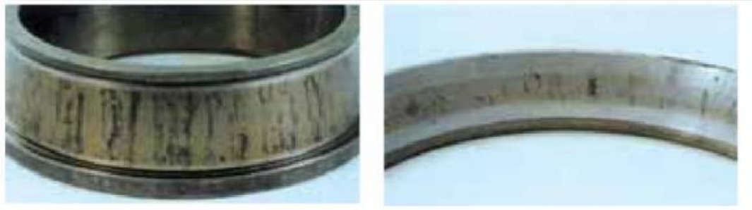
Fig. I.13 : Corrosion des pistes.
