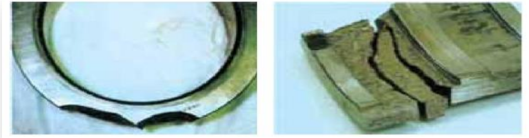
Fig. I.9 : Fissure et cassure des bagues.
