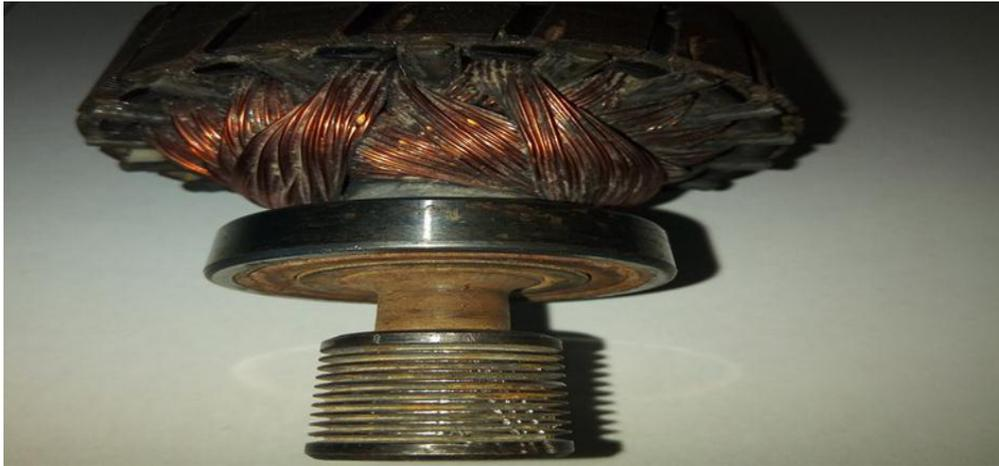
**Figure III.2 : Roulement arrière[6]**
