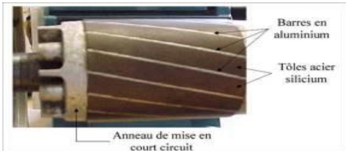
Figure. I.3 Rotor à cage d'écureuil
