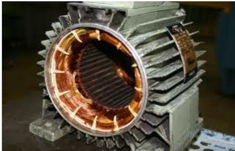
Figure. I.2 Photo du stator d'une machine asynchrone.
