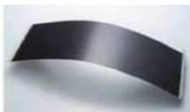
Fig (I.4) : cellule amorphe [ABA 11]
