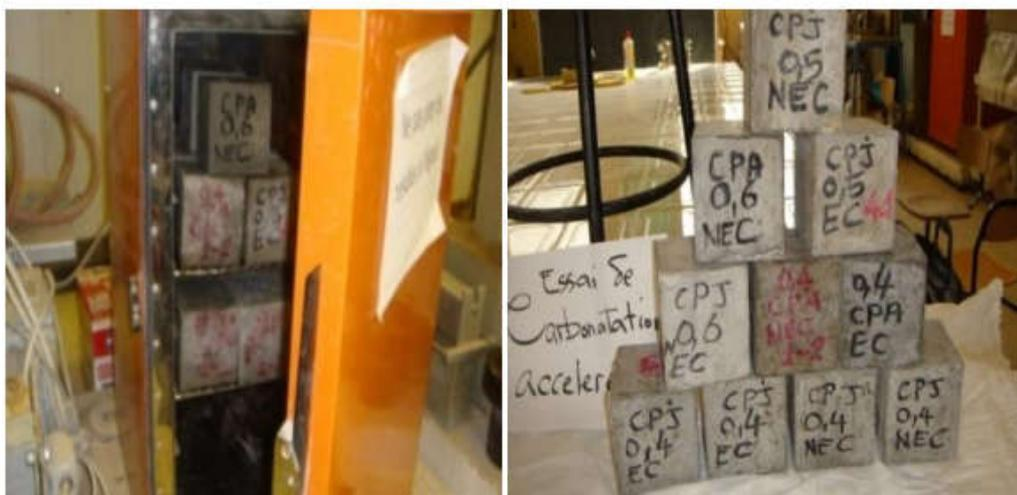
Figure 3.4 : Eprouvettes (10 × 10 × 10) cm<sup>3</sup> dans l'enceintes de carbonatation en conditions accélérées
