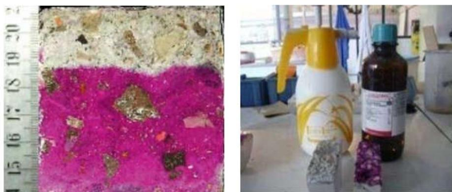
Figure 3.5 : Test à la phénolphthaléine et mesure du front de carbonatation
