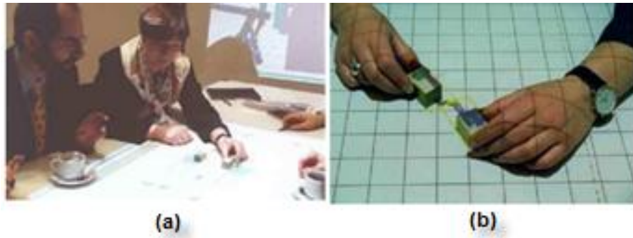
Figure I-6 Le système Build-IT (a) projection des objets virtuels sur la table du travail (b) interaction à deux mains.
