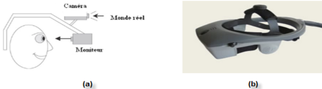
Figure I-13 Visiocasque vidéo : (a) principe de fonctionnement, (b) prototype expérimental.
