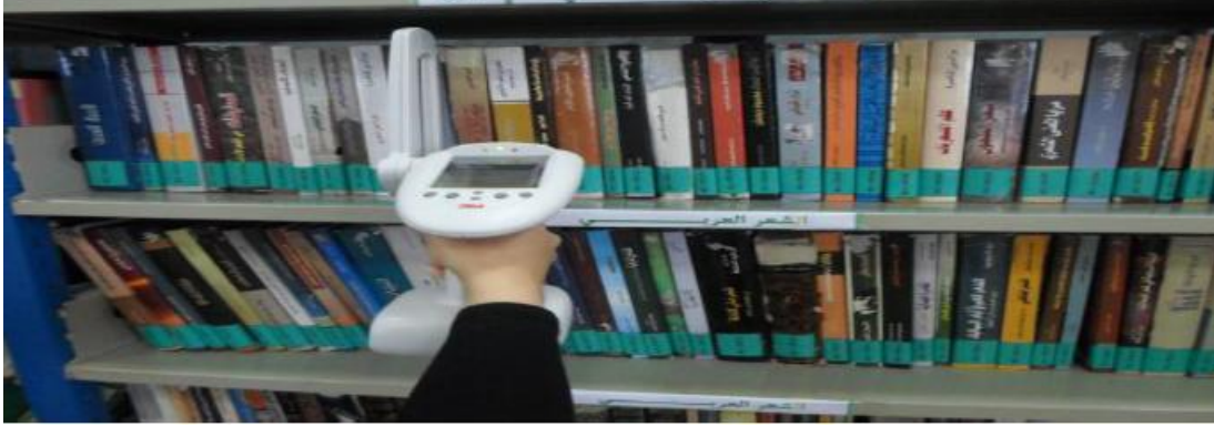
شكل رقم(09): صورة توضح عملية الجرد بواسطة تقنية RFID
