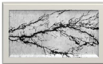
Figure 32 - La corrosion sous contrainte
