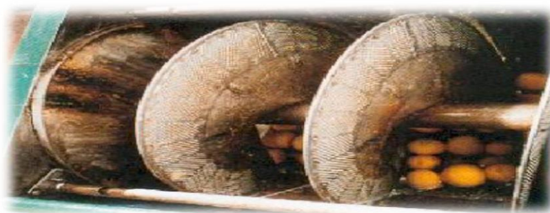
Figure 20 presse hydraulique pour la méthode d'expression à froid
