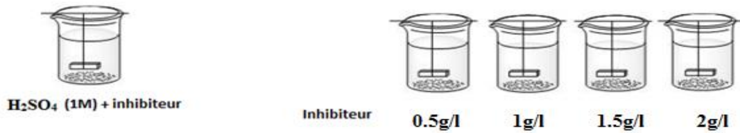
Figure 54 : Schéma du dispositif expérimental de corrosion avec inhibiteur
