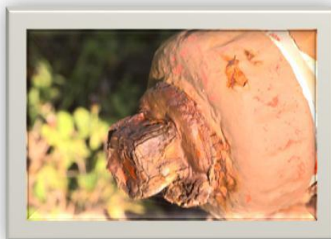
Figure 29 - La corrosion intergranulaire
