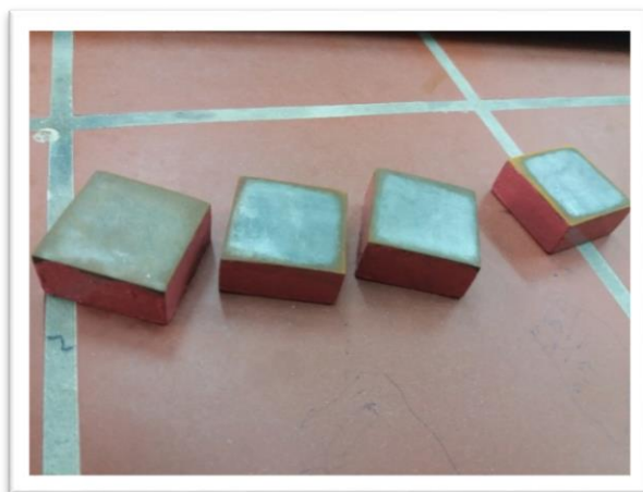
Figure 51 : L'échantillon préparé pour le microscope optique
