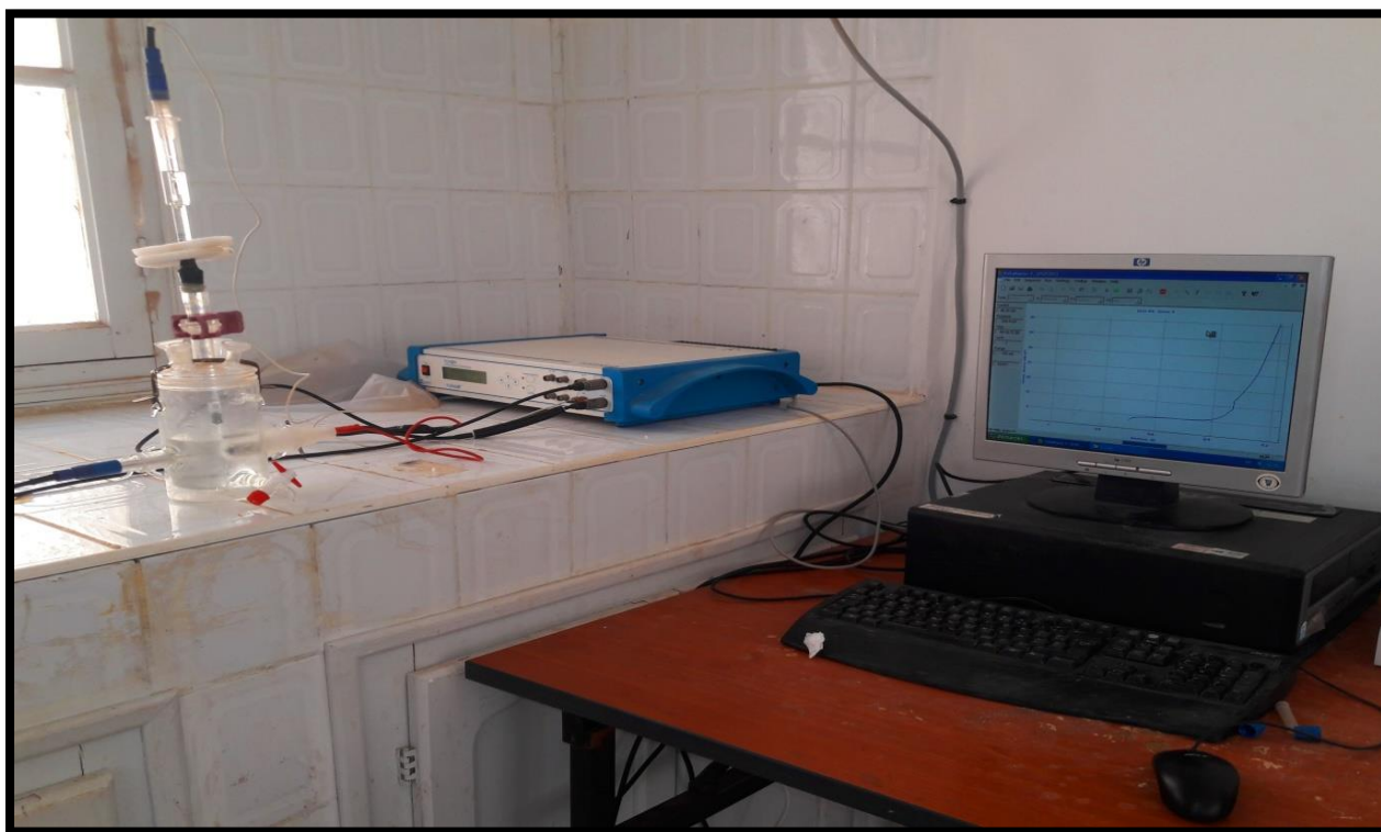
Figure. III.7. Dispositif de mesure électrochimique (VOLTALAB).
