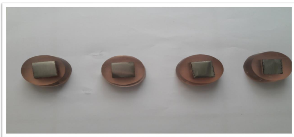
Figure III.6. Apparence des échantillons API 5L X70 avec revêtement de résine avant le test d'immersion.
