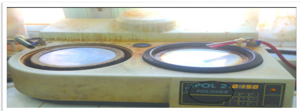
Figure. III.1. Photographies de l'appareil utilisé: polisseuse.
