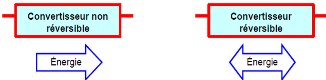
FIGURE 3.2 – Réversibilité et non réversibilité d'un convertisseur DC-DC, [17].
