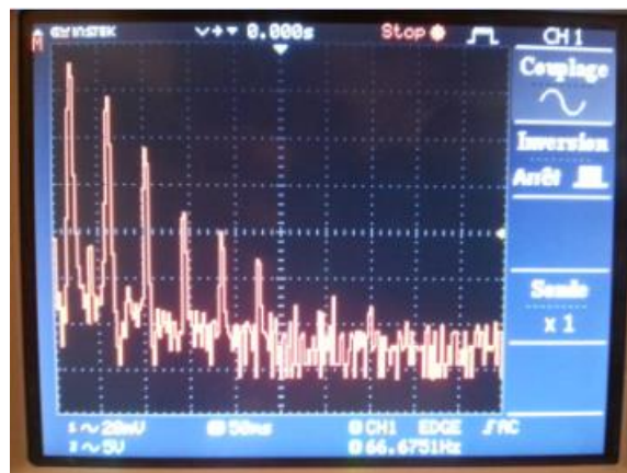
Fig.IV.32 le spectre des harmoniques du courant réel de saturation du transformateur
