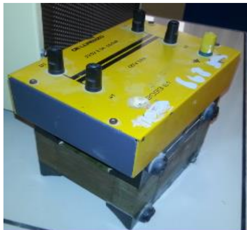
Fig.IV.1 Image réelle du transformateur monophasé utilisé dans l'expérimental
