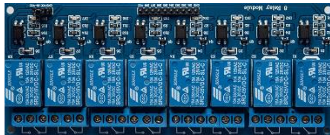
Figure 4.4 : Un relai de 8 canaux
