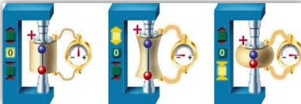
Figure (I-3) : Effet piézoélectrique direct. [9]
