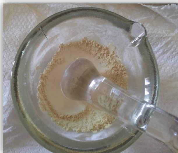
Figure (II-11) : Rebroyage après la calcination
