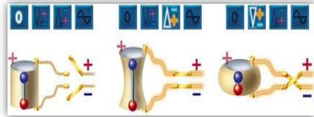
Figure (I-4) : Effet piézoélectrique inverse. [9]
