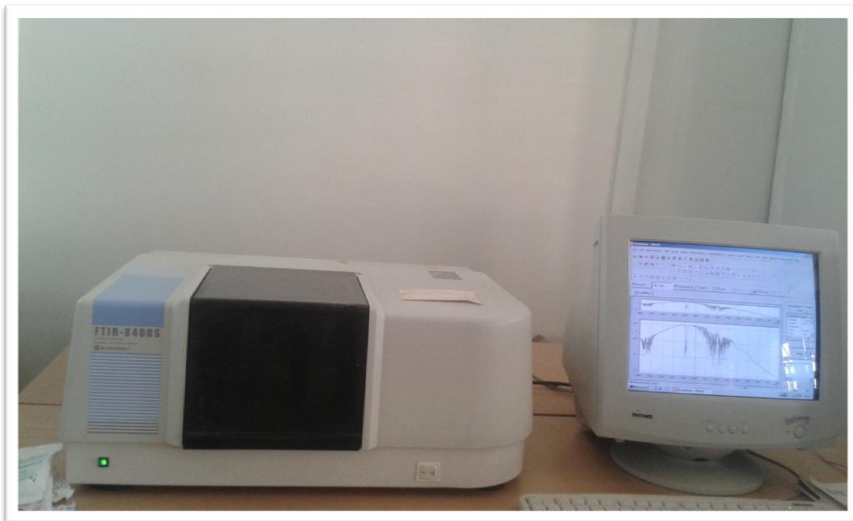
Figure II.6 : spectromètre Infrarouge à transformée de Fourier FTIR-Shimadgu 8400S.
