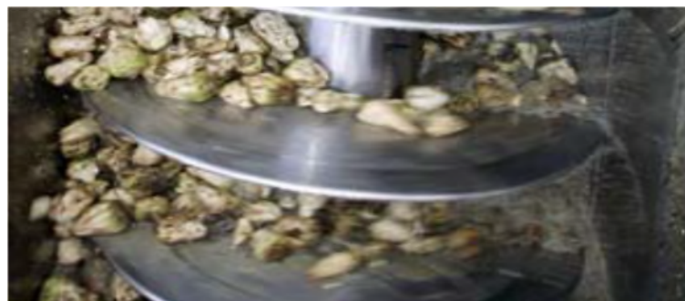
Figure I.10 : Lavage de betterave par lavoir à contre-courant.
