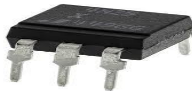
Fig. 3.8 image d'un optocoupleur
