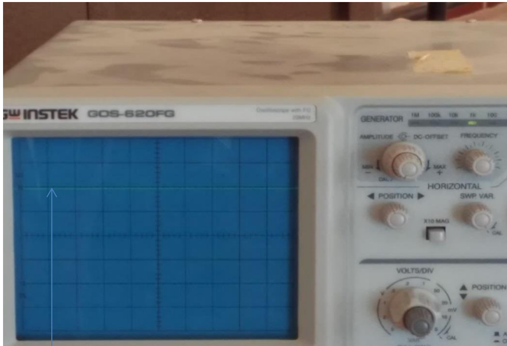
Fig.3.17 La tension de sortie (ou borne de la charge = 10 v)
