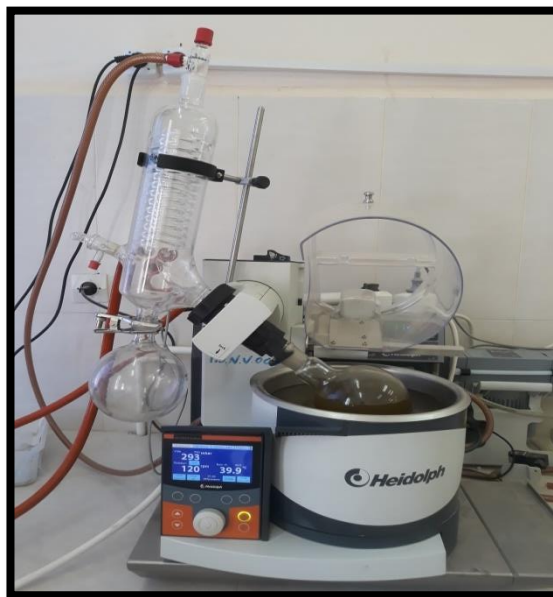
Figure 6. Elimination d'hexane par Rotavapeur Heidolph.
